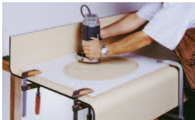
1. Vyznačit výřez a vyříznout jej frézou.
