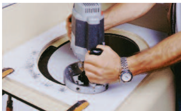
2. Drážkovat ze spodní strany ohýbaného dílu Compactforming prostřednictvím tyčové frézky nebo CNC obráběcího centra
